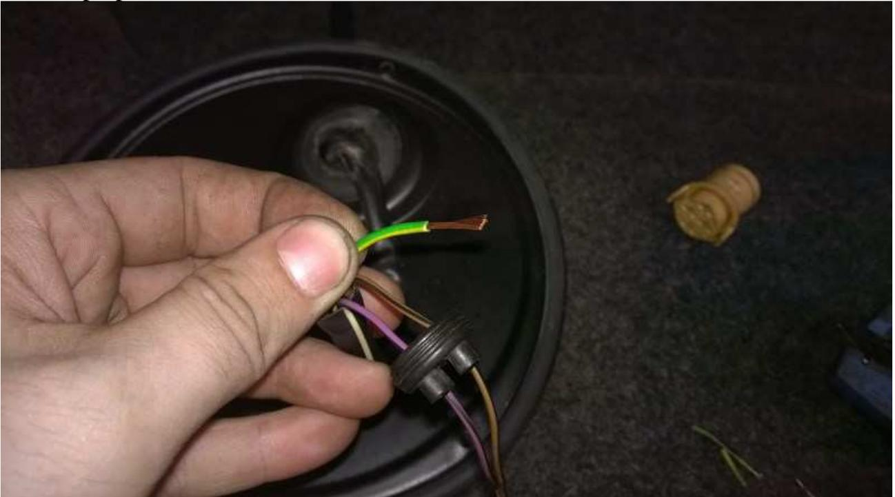
On passe le faisceau par la cloison derrière la banquette (pas nécessaire d'enlever le dossier)
