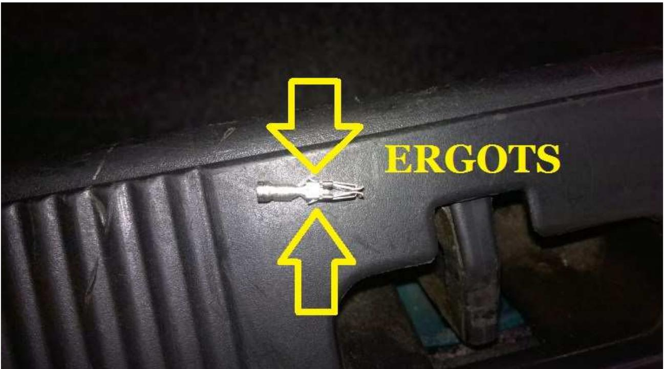
Si on ne remplace pas le connecteur de la pompe, il est utile de savoir quels fils il faut retirer. Donc une fois face à la prise, voici les 2 fils en questions
