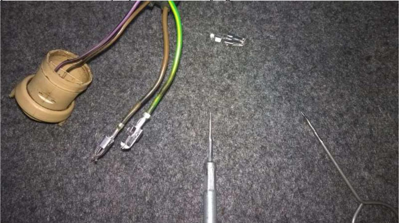
On coupe les 2 fils au bord des cosses et on sort les fils du passe-fils en caoutchouc
