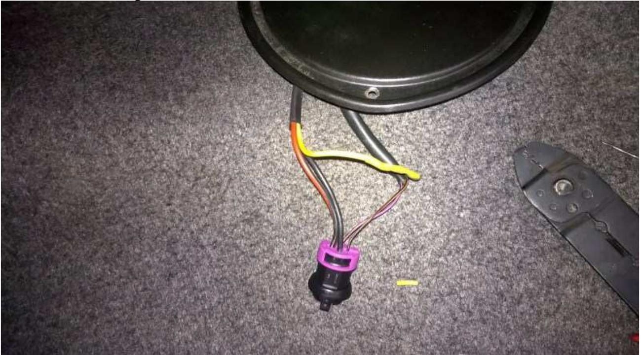
Avec la toile isolante, on fait un petit assemblage propre afin de préserver le tout de la poussière et de l'humidité
