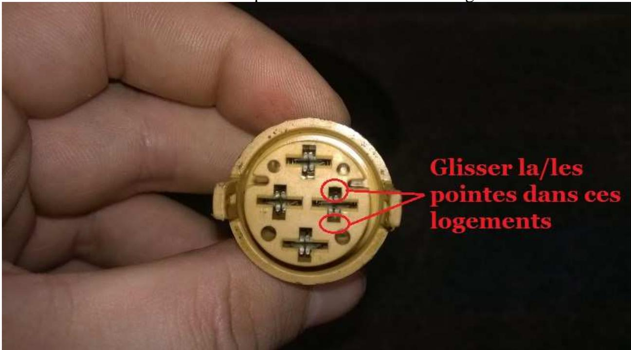
C'est récalcitrant et ça tient bien donc ne pas tirer sur les fils à l'arrache sinon on risque de se retrouver avec le fil en main mais la cosse toujours dans le connecteur...
