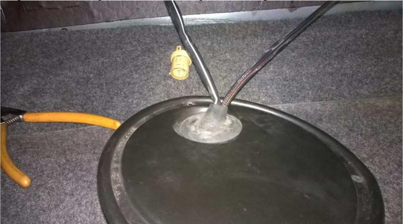
Les nouveau fils pour l'alim et la masse de la pompe sont en  $\text{Ø } 2,5\text{mm}^2$  et il faudra donc un peu élargir le passage du passe-fils (perso j'ai utilisé une pince à ouvrir mais possible aussi avec un peu de WD40)
