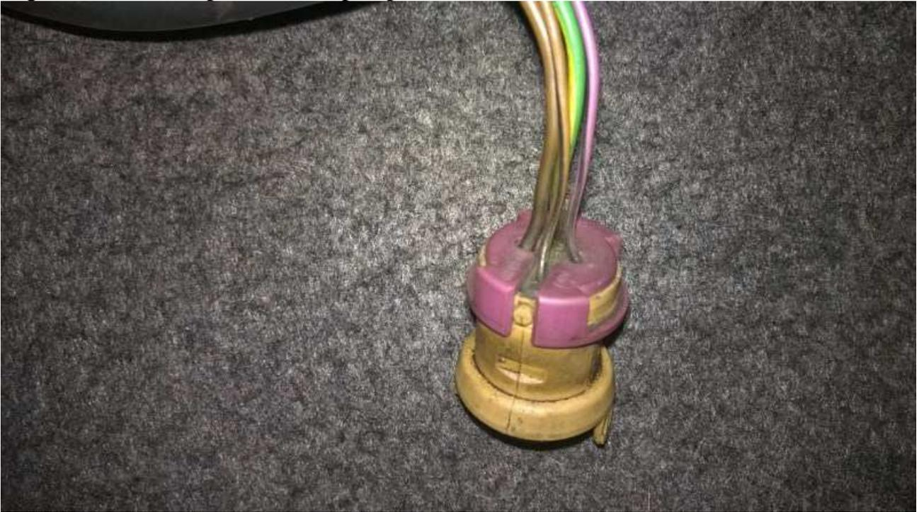
On retire la sùreté mauve en la soulevant à l'aide du tournevis plat
